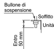
● **Spazi minimi di installazione e di manutenzione**
