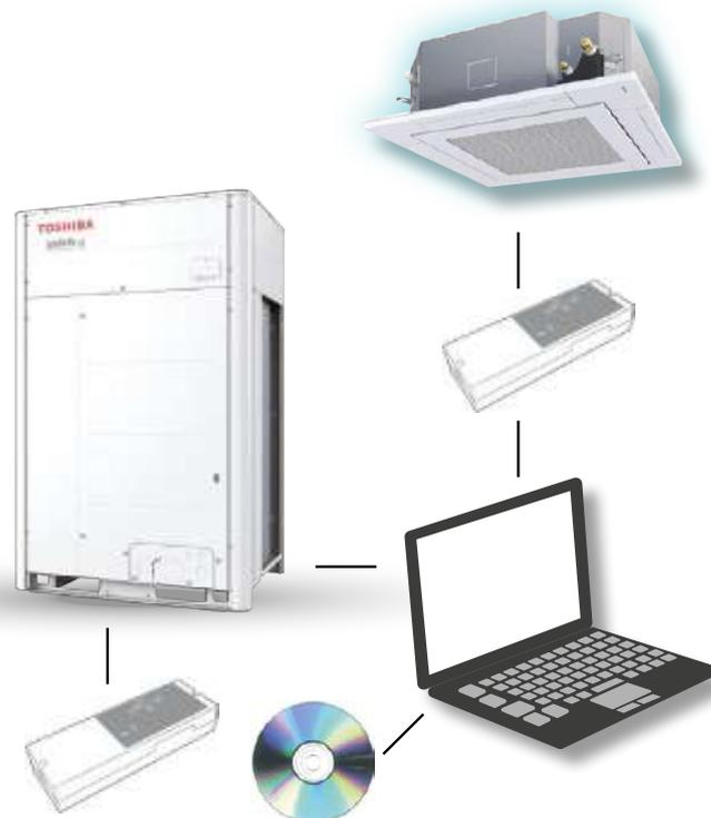
DynaDoctor per VRF analizza i dati inviati dal Dynakit e supporta nella visualizzazione dello stato delle unità interne. Questo strumento può essere utilizzato per controllare i dati del ciclo del refrigerante, visualizzare vari dati grafici, eseguire test su unità interne e creare report dei risultati. Inoltre, i dati ricevuti possono essere salvati e sfogliati e l'uso secondario dei dati può essere effettuato facilmente.
