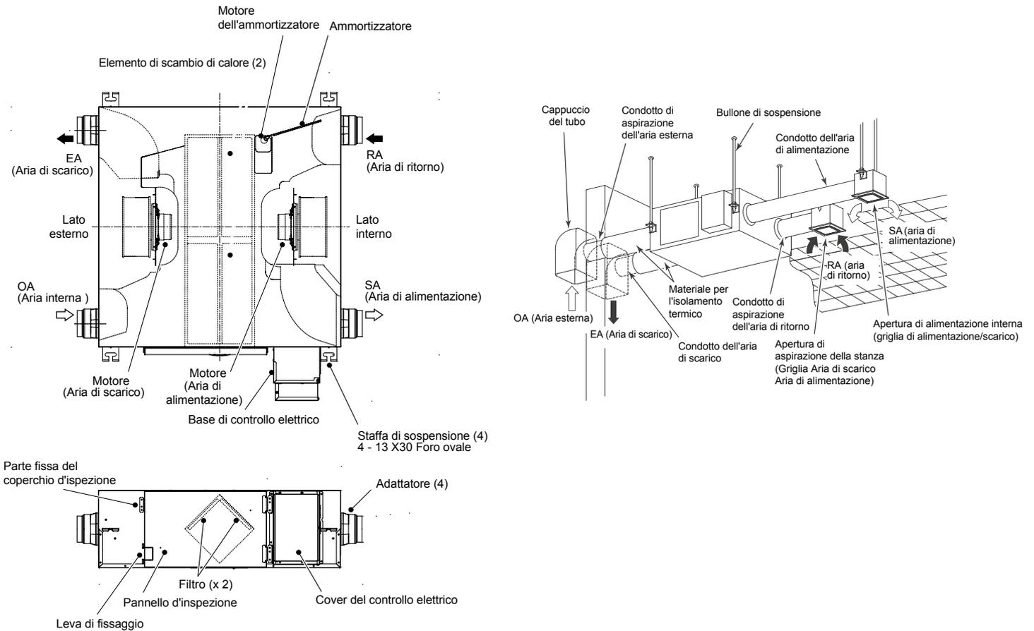
**SCAMBIATORE DI CALORE ARIA-ARIA**
